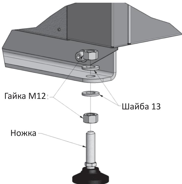
В комплектации котла находятся дополнительные регулирующие ножки, которые позволяют на прочную установку котла на полу.
