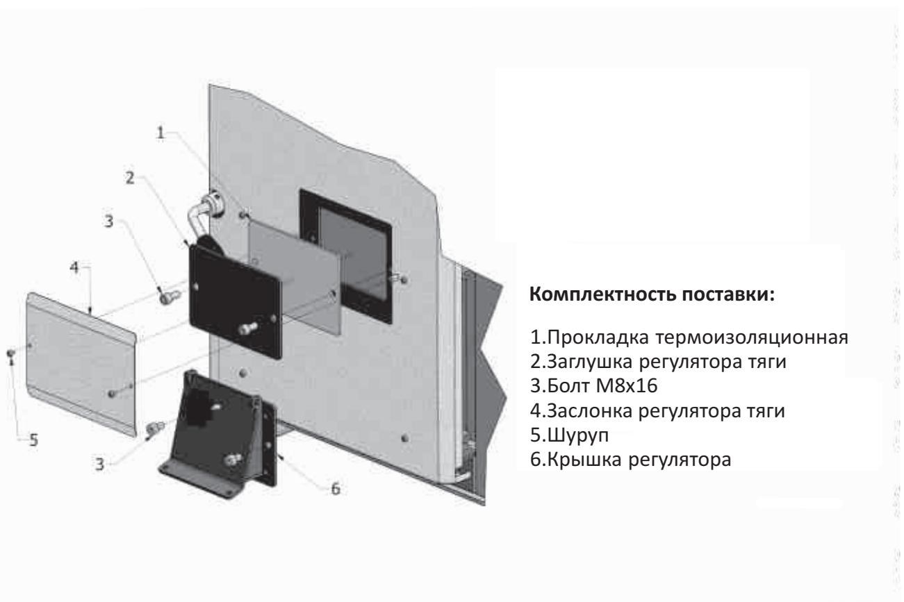
Рис. 15. Установка крышки регулятора тяги.
